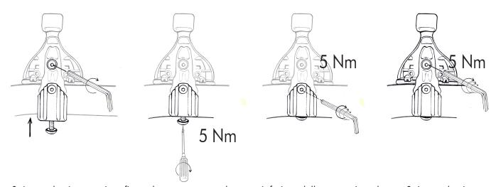
Stringere la vite superiore fino ad accompagnare la parte inferiore della ganascina al tetto. Stringere la vite inferiore arrivando a fine corsa. Stringere con forza la vite di congiunzione della ganascia. Stringere con forza la vite superiore facendo ATTENZIONE a non spostare la centratura delle barre. Per ottenere il risultato corretto stringere le viti alternando il lato destro al lato sinistro in maniera uniforme.
