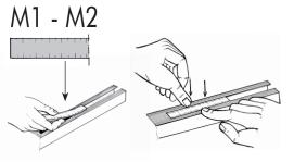
Inserire il metro tagliato in misura M1 nelle 2 cave della barra anteriore, portandolo fine a fine corsa.
