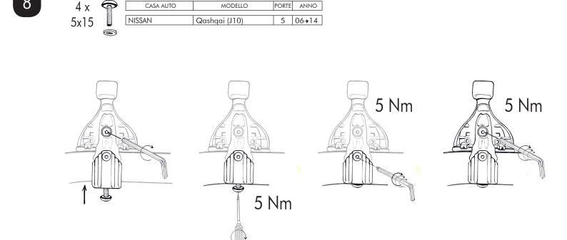
Stringere la vite superiore fino ad accompagnare la parte inferiore della ganascina al tetto. Stringere la vite inferiore arrivando a fine corsa. Stringere con forza la vite di congiunzione della ganascia. Stringere con forza la vite superiore facendo ATTENZIONE a non spostare la centratura delle barre. Per ottenere il risultato corretto stringere le viti alternando il lato destro al lato sinistro in maniera uniforme.
