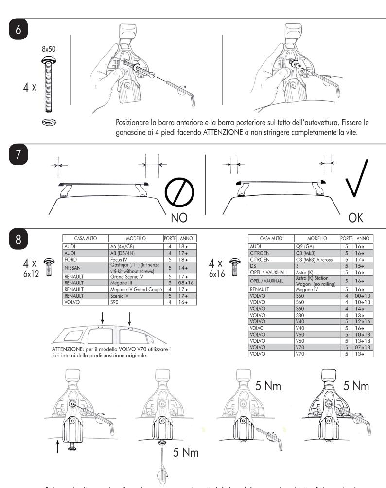
Stringere la vite superiore fino ad accompagnare la parte inferiore della ganascina al tetto. Stringere la vite inferiore arrivando a fine corsa. Stringere con forza la vite di congiunzione della ganascia. Stringere con forza la vite superiore facendo ATTENZIONE a non spostare la centratura delle barre. Per ottenere il risultato corretto stringere le viti alternando il lato destro al lato sinistro in maniera uniforme.
